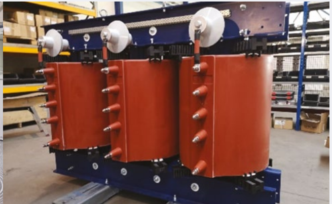
Korndorfer Gießharzsparttransformator 3018 kVA bei 6,6 kV, 50 Hz 11/6,6 kV, Isolationsklasse 28 kV, Impulspegel 75kVp, Übertemperatur 85/85°C, Schaltgruppe YNa0. Installation an Bord des Schiffes. Zielort: Großbritannien.
